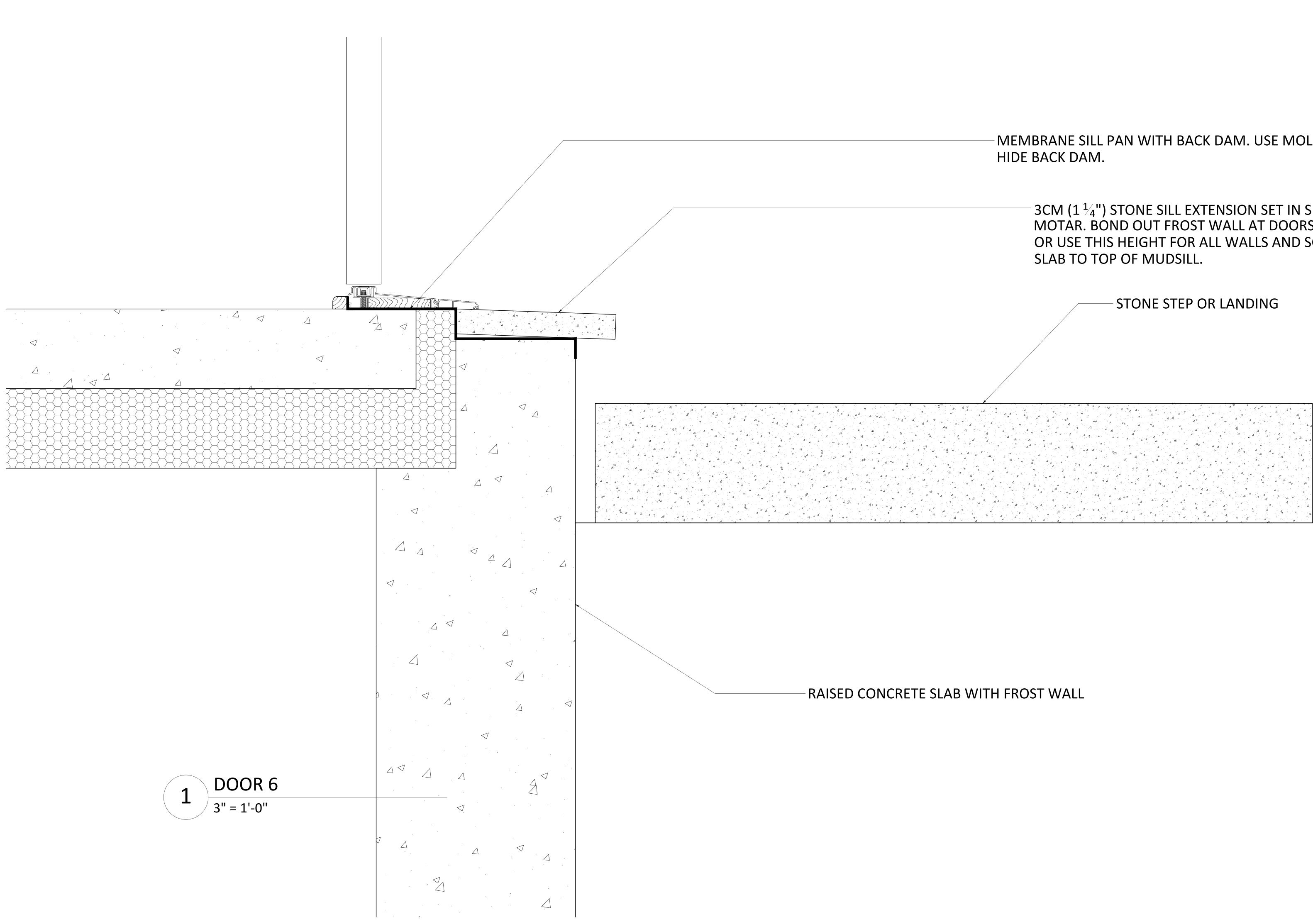
MEMBRANE SILL PAN WITH BACK DAM. USE MOLDING TO
